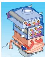
Поскольку в данной структуре выхлопные газы проходят 4 этапа теплообмена после сгорания, теплопроизводительность очень высока, как результат, тепло сохраняется в течение длительного времени для нагревания большого количества воды и обеспечения быстрого обогрева.
